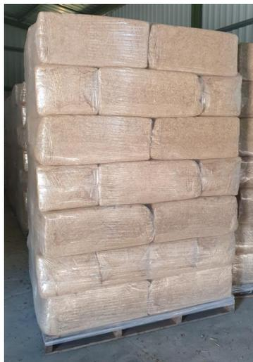
L'isolant à base de paille sera soit stocké en vrac dans les 4 tambours des mélangeuses de 50 m<sup>3</sup> dans le bâtiment, soit stocké en sac plastique de 94 litres.
