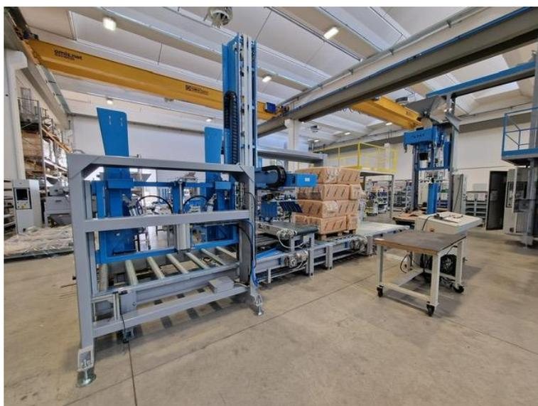
**PHOTO 3 : MODELE DU PALETISSEUR DE BALLE D'ISOLANT QUI SERA IMPLANTE**
