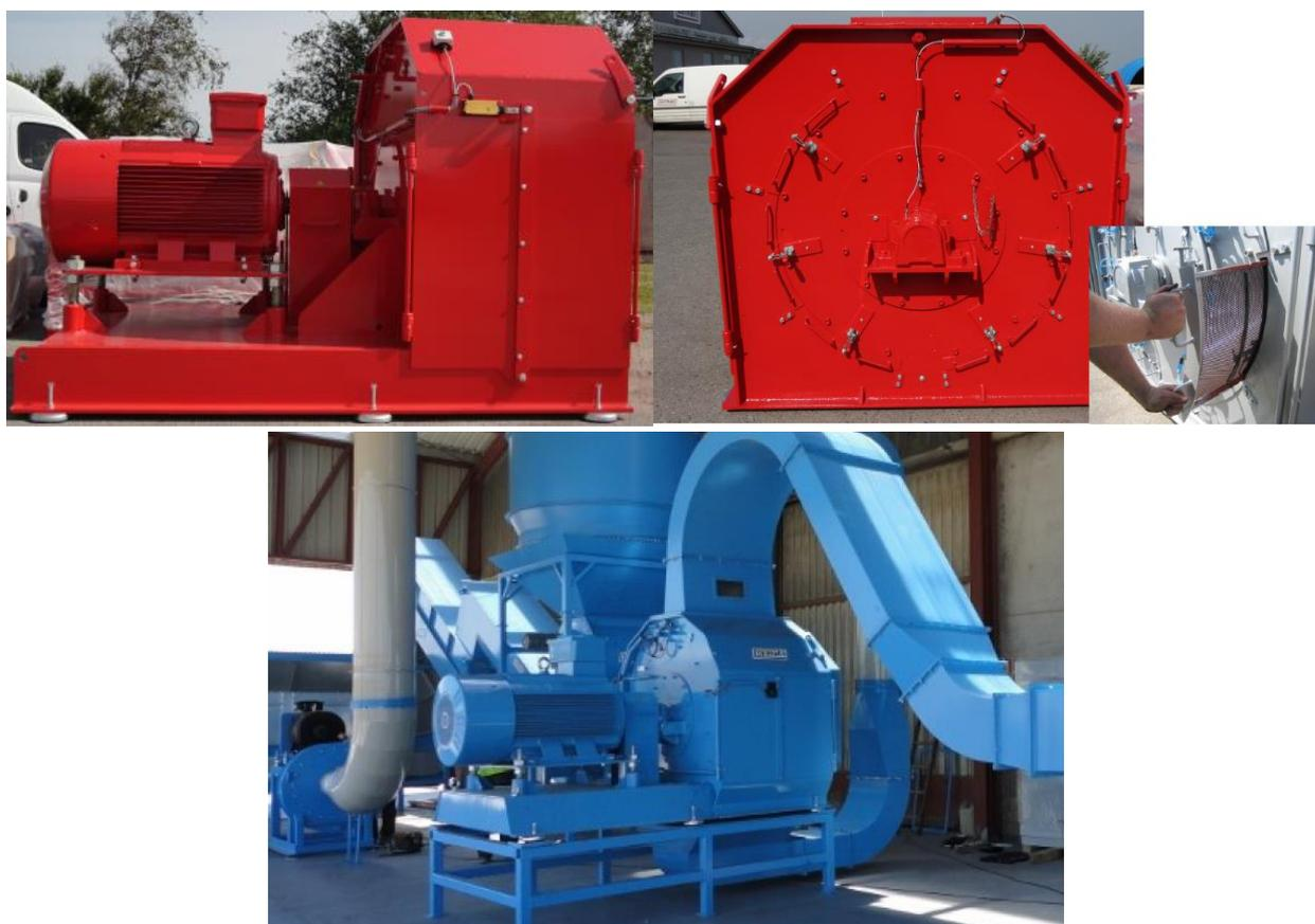
**PHOTO 2 : MODELE DU BROYEUR QUI SERA INSTALLE ET DES GRILLES DE CALIBRAGE**
